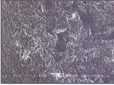
صورة رقم (٦) لعينة الالباستر المصري تحت الميكروسكوب الاليكتروني الماسح SEM بتكبير 1500X تبين تدهور وتآكل في بلورات الكالسيت و زيادة في مسامية الحجر Increase in porosity وانتشار الفراغات بين البلورات وبعضها .
