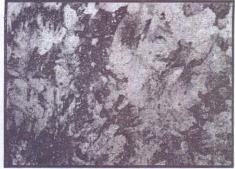
صورة رقم (١) تبين عينة لقطاع من الالباستر المصري (تحت المستقطبين المتعامدين C.N) (X4) ، يظهر بها شروخ دقيقة micro fissures وفقد في نسيج الحجر مع وجود فجوات ، ، كما يظهر بالقطاع بعض بلورات الكالسيت الغير متبلورة amorphous carbonates
