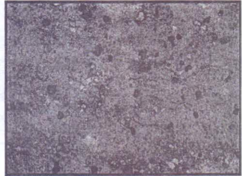
صورة رقم (٣) تبين عينة لقطاع من الالباستر المصري (الواجهة الجنوبية الشرقية) (أسفل الضوء المستقطب PPI) (X4) ، تبين وجود ثقوب مع انتشار الفجوات والفراغات بنسيج الحجر
